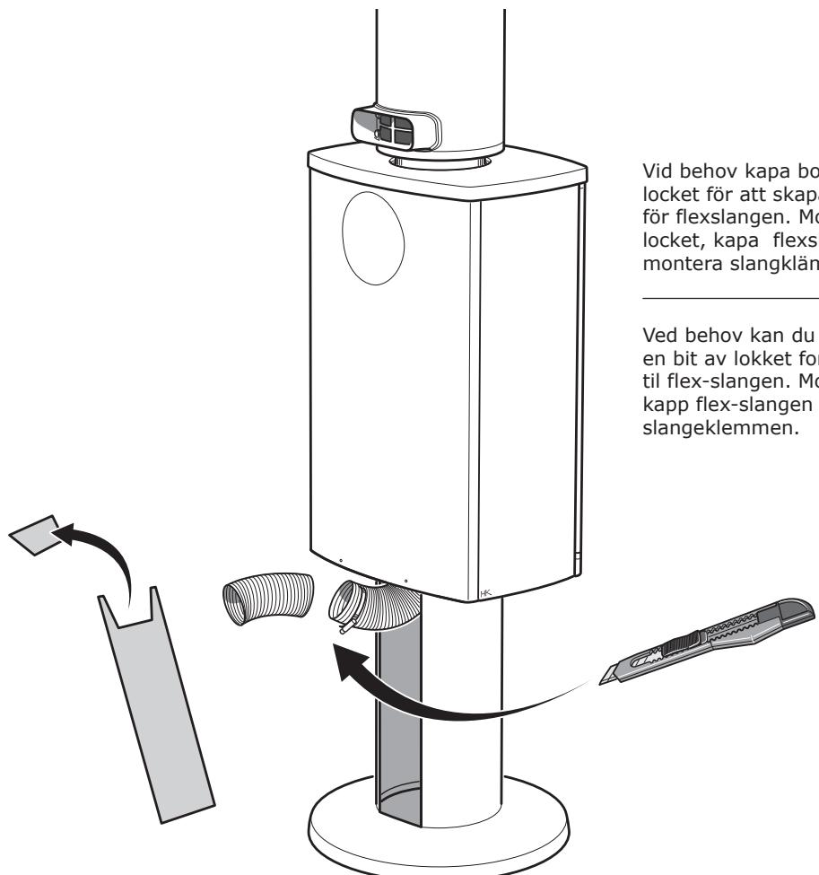
Vid behov kapa bort en bit i locket för att skapa utrymme för flexslangen. Montera locket, kapa flexslangen och montera slangklämmnan.
