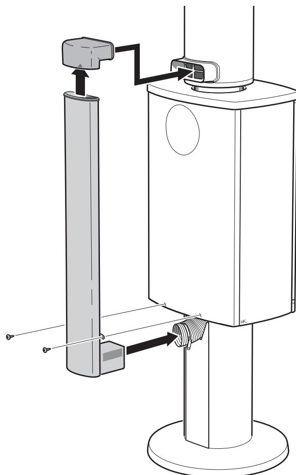
För ihop delarna, skruva fast tilluftskanalen och spänn slangklämmnan.
