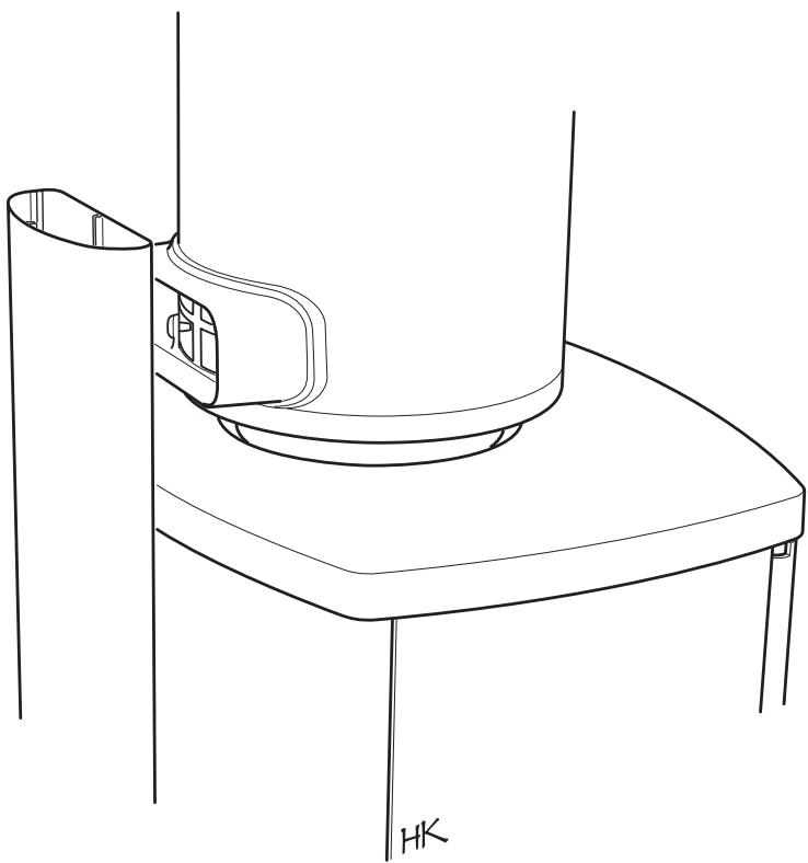
I de flesta fall behöver längden på tilluftskanal och tilluftsvinkel anpassas. Läs i den ordinarie installationsanvisningen hur delarna kapas och skruva av tilluftskanalen.
