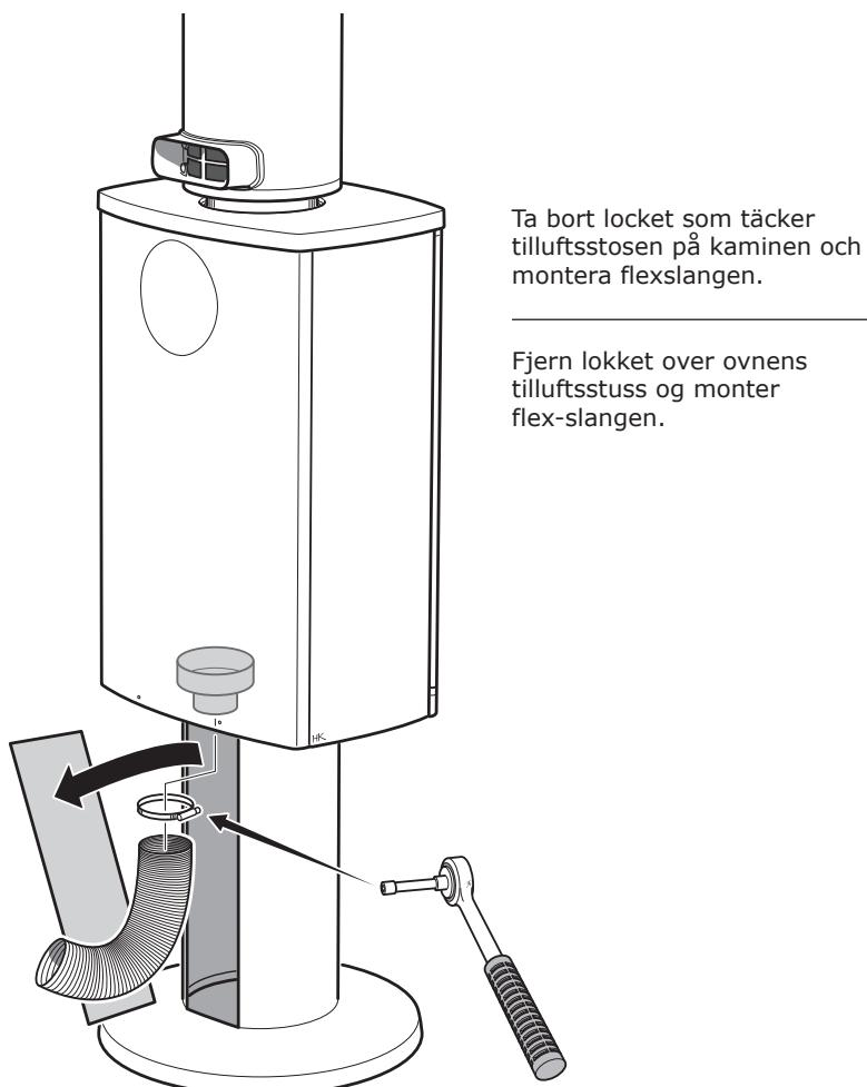
Ta bort locket som täcker tilluftsstossen på kaminen och montera flexslangen.
