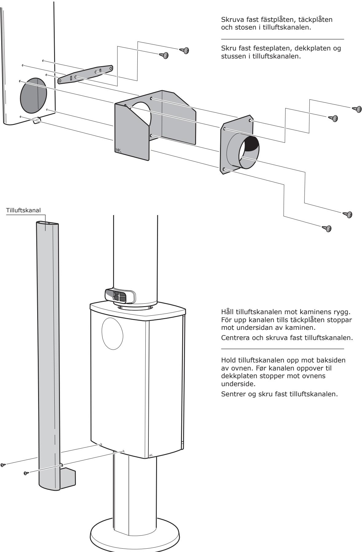
Skruta fast fästplåten, täckplåten och stosen i tilluftskanalen.
