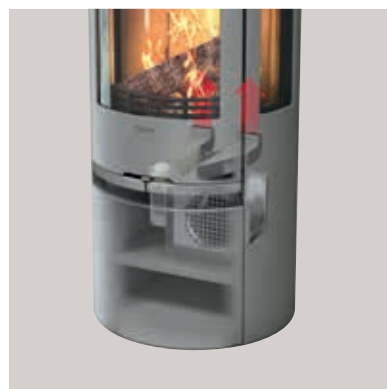
Vifte. Gir rask fordeling av varmen og jevnere temperatur. Termostatstyrt; den starter automatisk når du fyrer og stanser når ilden har sluknet. Enkel å montere, selv i ettetid.
